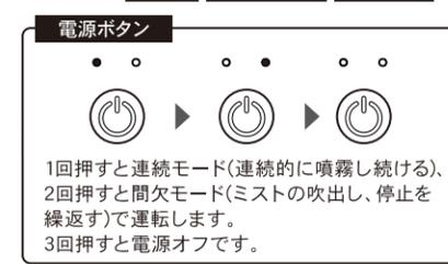
1回押すと連続モード(連続的に噴霧し続ける)、2回押すと間欠モード(ミストの吹出し、停止を繰り返す)で運転します。3回押すと電源オフです。
