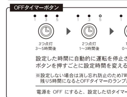
設定した時間に自動的に運転を停止させますが、ボタンを押すごとに設定時間を変えることができます。※設定しない場合は消し忘れ防止のため7時間後に電源が切れます。残り5時間になるとOFFタイマーのランプが3つ点灯します。電源をOFFにすると、設定した切タイマーがリセットされます。
