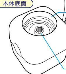
ボトルねじ：ペットボトルを取り付けます。
